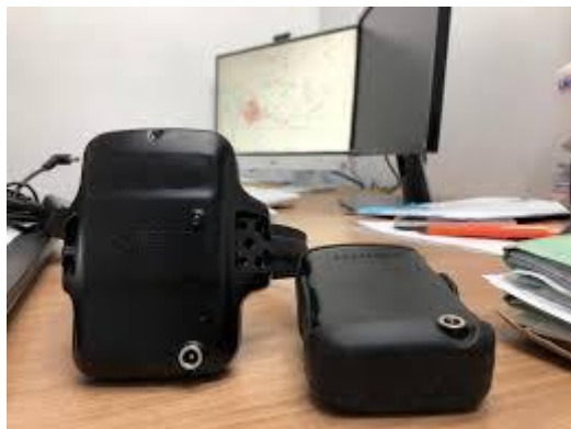
Imagem 9: Tornozeleira eletrônica e botão do pânico disponibilizado pelo serviço judiciário Foto: SESP/MT 8
